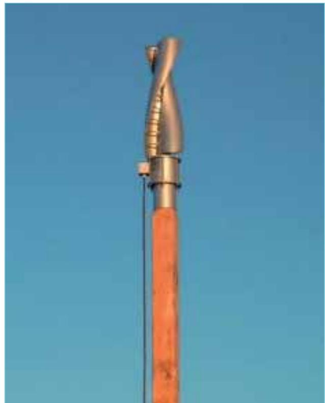
Figure 16 : Eolienne à axe vertical (document CAP ENR).
