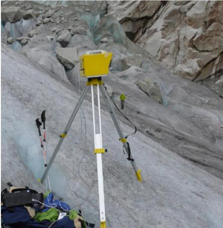
Figure II.3. – Le scanner laser ILRIS 3D en action au pied des échelles de l'Envers des Aiguilles (L. Ravanel, 2014).
